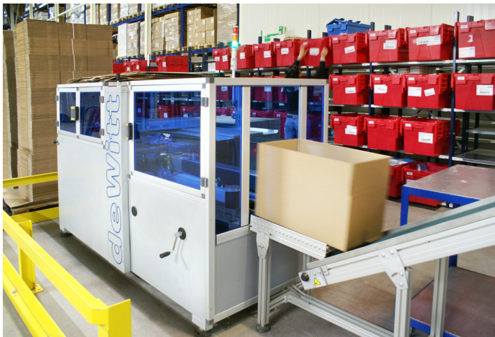
Met de ingebruikname van een automatische dozenopzetmachine werd ook de toevoer van de orderdozen geoptimaliseerd
