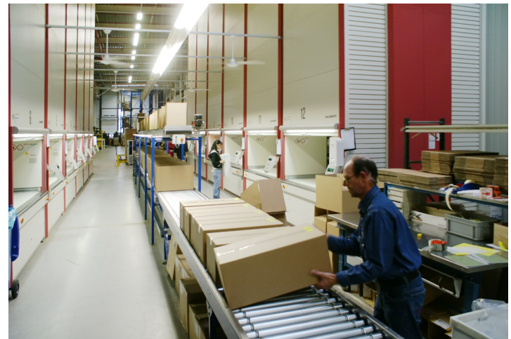
Via een rollenbaan wordt de complete batch van 20 orders in één keer naar het inpakstation getransporteerd
