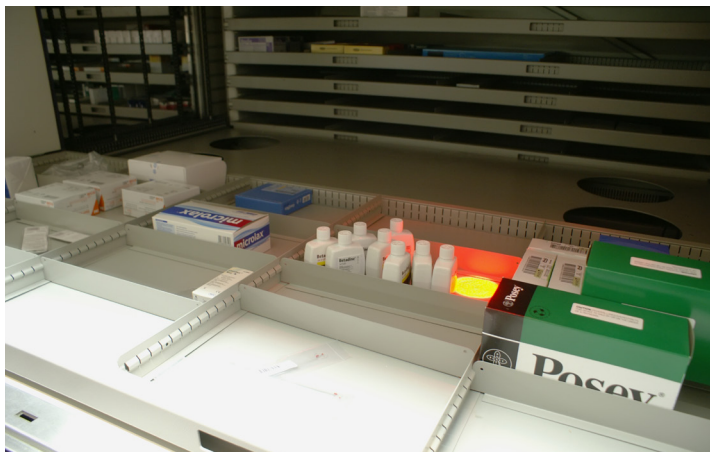
Een rode stip geeft de juiste picklocatie in de container aan. Dankzij dit pick-to-light systeem werd het foutpercentage meer dan gehalveerd
